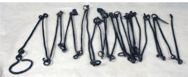
Ответ: цепь мерная (электронная) геодезическая
