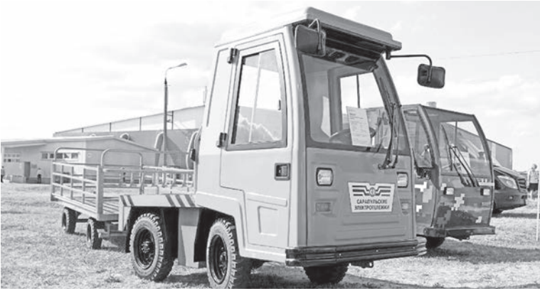
Новый тягач на базе серийной электротележки
