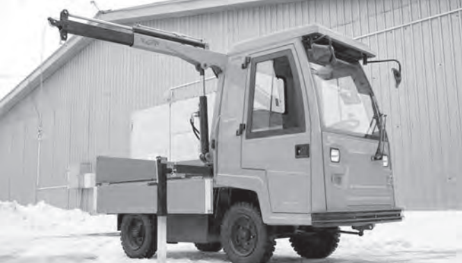
Электротележка с краном-манипулятором АО «СЭГЗ»
