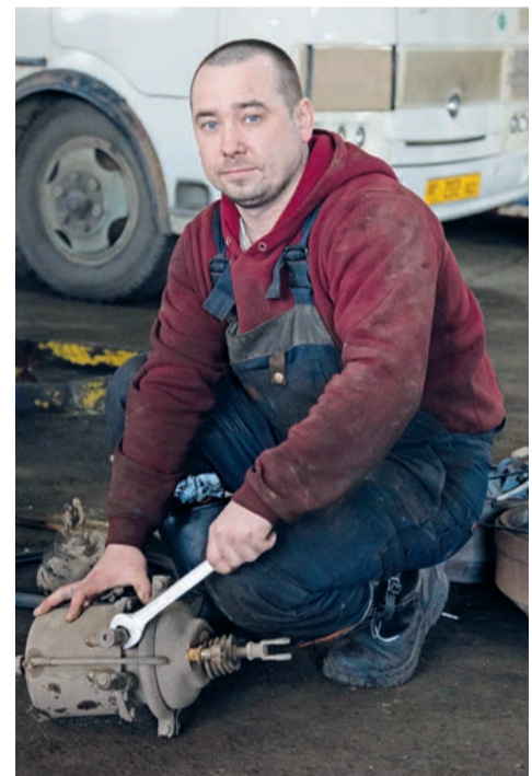
Иван Чечерин проверяет тормозную систему автобуса
