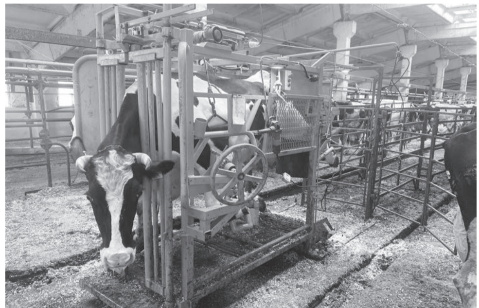
Станок для обрезки копыт КРС весит почти 800 килограммов. За день можно обработать конечности у 50-80 коров
