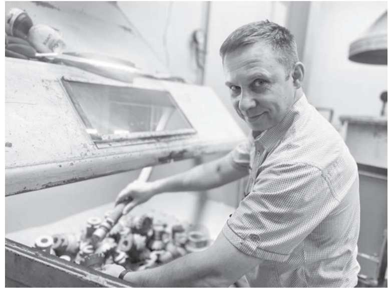
Старший мастер участка литья по выплавляемым моделям Виктор Новоселов знакомит с процессом механической зачистки
